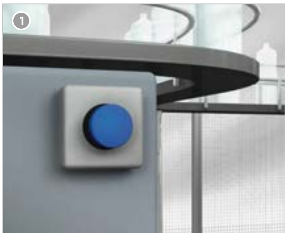
Расположенная непосредственно на машине локальная кнопка предварительного сброса, которую следует нажать до полного сброса системы обеспечения безопасности.
